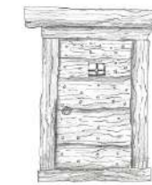
Encadrements de baie en bois
