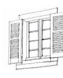
Encadrement et appuis de fenêtre simple en pierre de taille
