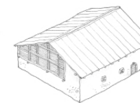
Toiture à deux pans
