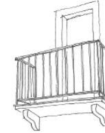
Balcons soutenus par des consoles et ferronnerie des garde-corps
