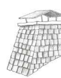
Souche de cheminée à ancelles
