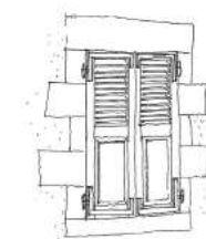
Encadrement de baie harpé Contrevents persiennés Chaînage d'angle harpé, en granit
