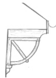
Aisselier bois sculpté Ferme apparente en façade (sous-arbalétrier, blochet poinçon, etc.)
