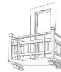
Balcon dalle maçonnée et garde-corps en bois
